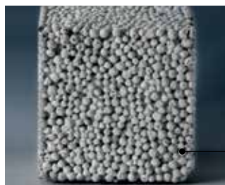
Ausgehärteter Poriment P im Querschnitt Ausgehärteter Poriment LS im Querschnitt
